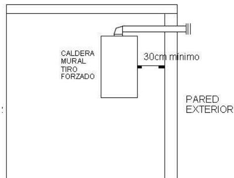
Figura IIg – 1 Salidas de Humo en Tiro Balanceado Forzado
